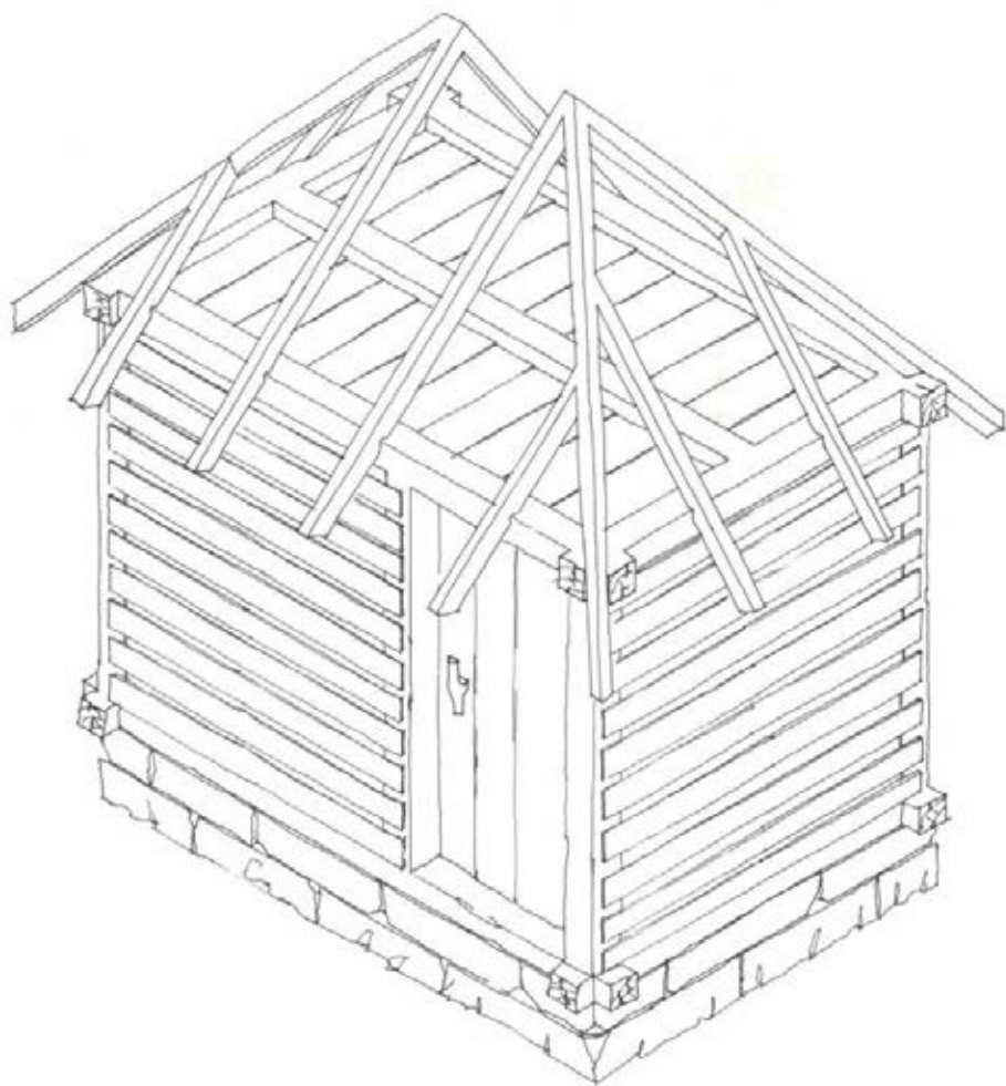
Слика 21. Колиба с ѱланине Повлен (консѱрукѱија „на ѱриковце”) – консѱрукѱивни склоѱ
