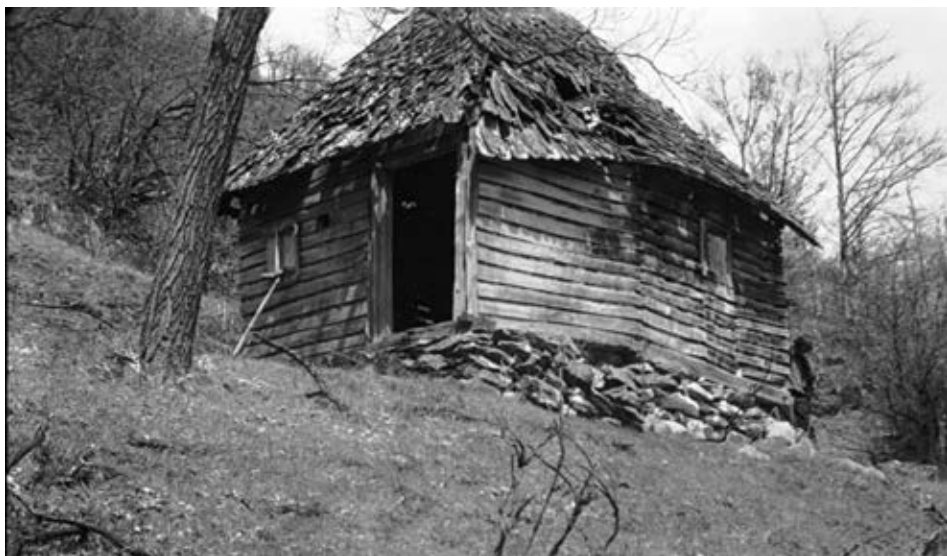
Слика 19. Колиба „на ѝриковце” с ѝланине Повлен ѝокривена дрвеном щиндром
