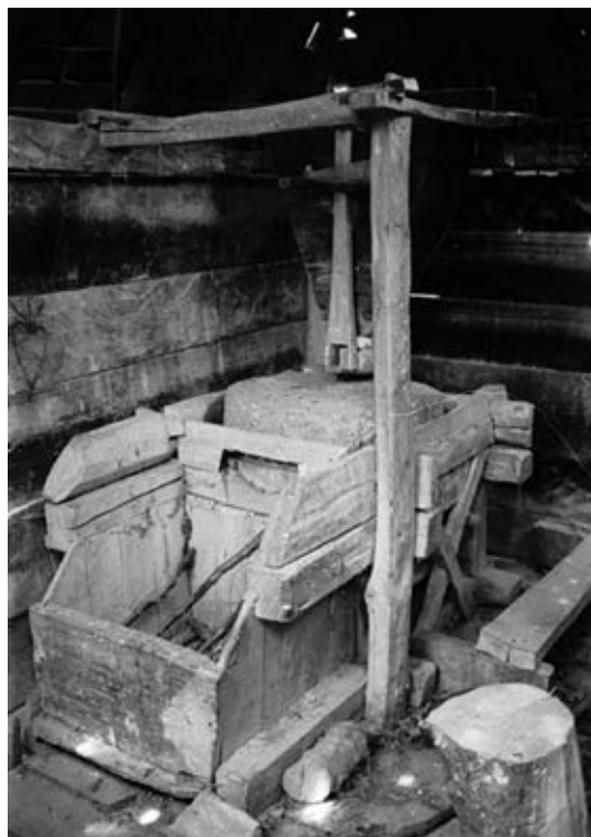
Слика 18. Воденички камен и констѐрукција млина, село Маковицѝе
