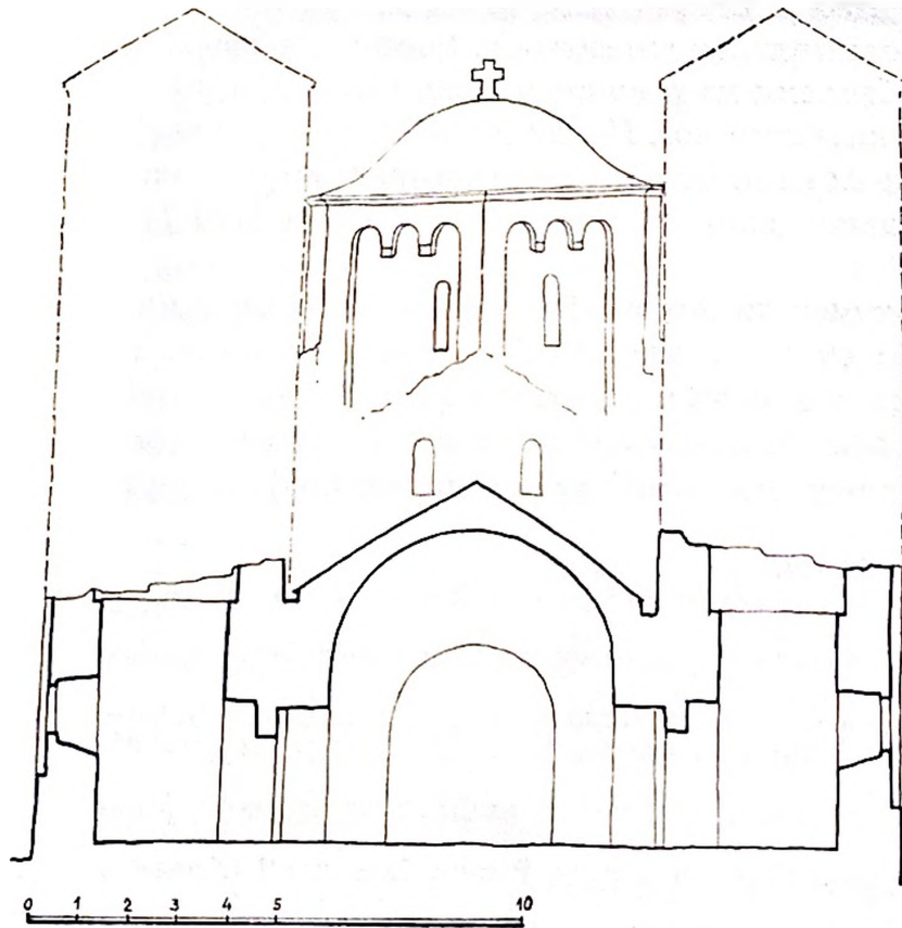
Црт. 2. Бурђеви Ступови у Расу. Попречни пресек кроз куле
